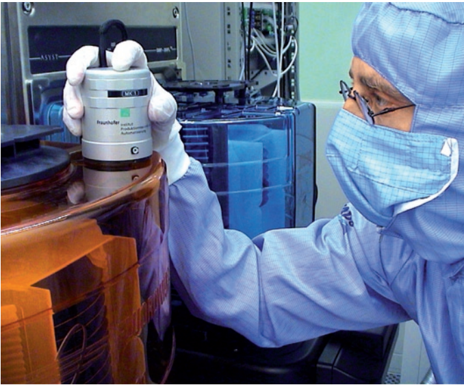
Abb. 3: Partikelmessungen mit optischen Partikelzählern an einer Roboterachse im Dauerbetrieb.
