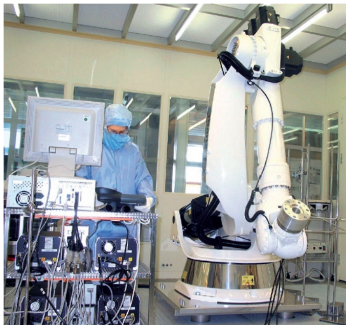
Abb. 1: Messung sedimentierter Partikel auf technischen Oberflächen (Behälter für 300mm-Wafer).
