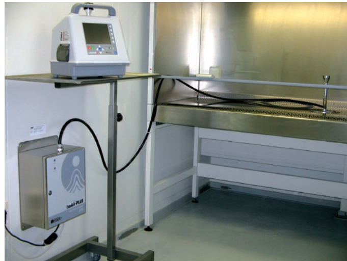
Abb. 2: Darstellung der Messgeräte für das Partikelmonitoring in den Klassen A und B
